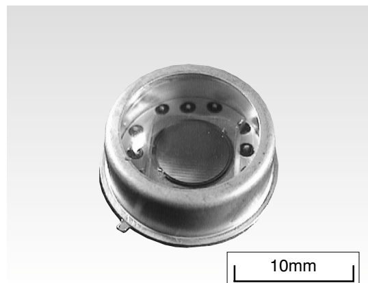
Fig. 1 A photograph of the packaged ultraviolet AlGa N photodiode AlGa N 受光素子パッケージ写真
