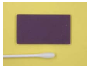
図 1 2160 -70 濃紫 504 時間浸せき後の外観
