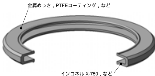
図 1 メタルレジリエントシールの断面形状 (代表例：Uタイプ)
